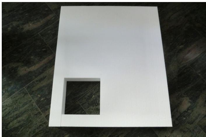
**Die notwendigen Aussparungen für Rohre und Anschlüsse können mittels Säge ausgeschnitten werden und mit einem Montageschaum oder vergleichbarem verfüllt werden, um die vollflächige Verklebung und Standsicherheit zu gewährleisten. Die Bearbeitung mit Heißdraht und Schneidegeräte ist ebenso möglich wie das einfache Schruppen mit einer Drahtbürste.**
